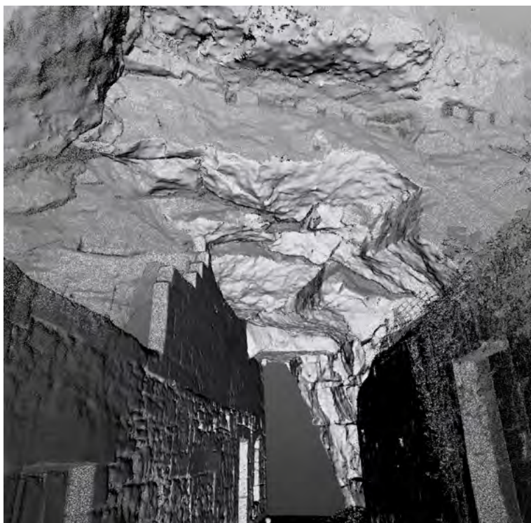
Figure 21 : exemple de scanner laser 3D d'une falaise sous-cavée, à gauche la photographie et à droite le résultat d'un levé par scanner 3D (Source : Ineris)
