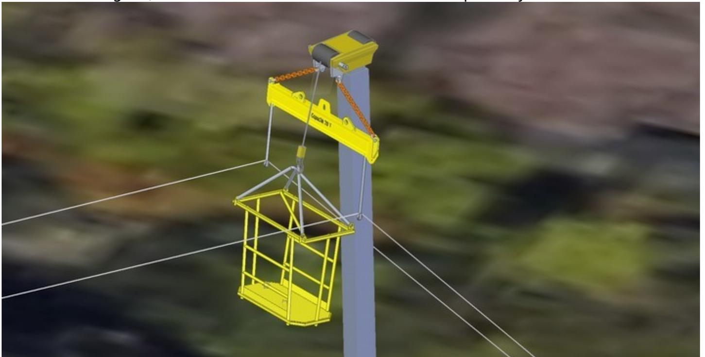
Pour garantir que le câble de la grue (qui lève la nacelle) ne frottera pas sur le palonnier, nous envisageons de passer une sangle en V entre 2 oreilles du palonnier et la flèche de la grue.
