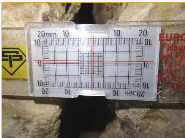
*Modèle de fissuromètre en place dans plusieurs cavités du site*
