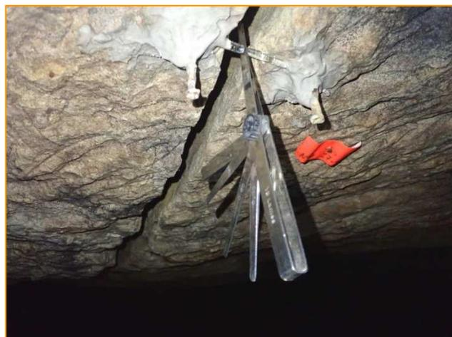
*Témoin de fissure en verre aminci au centre et crocheté sur des clous avec du ciment prompt. Sur cet exemple où le témoin, est cassé, le contrôle de l'écartement se fait avec un jeu de cales d'épaisseur.*
