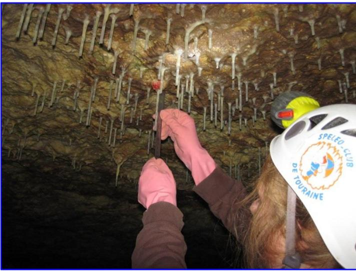
Mesure de la croissance d'une stalactite repérée par un point rouge et mesurée en 1983.
